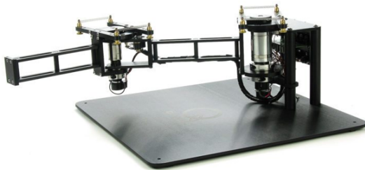
Fig. 1. Brazo Robot de 2 Grados de Libertad y Articulaciones Flexibles Quanser
