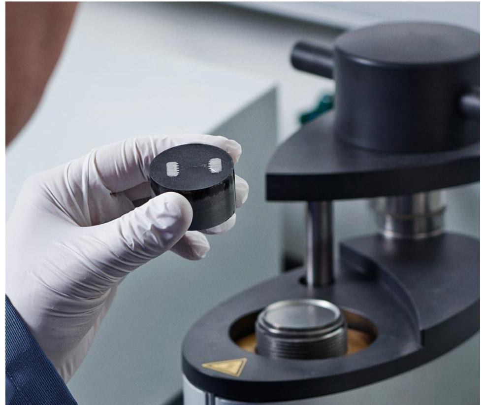
Extracción de cápsula de resina de la prensa metalográfica [3]
