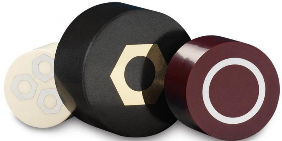
Cápsulas endurecidas en caliente con muestras en su interior [4]
