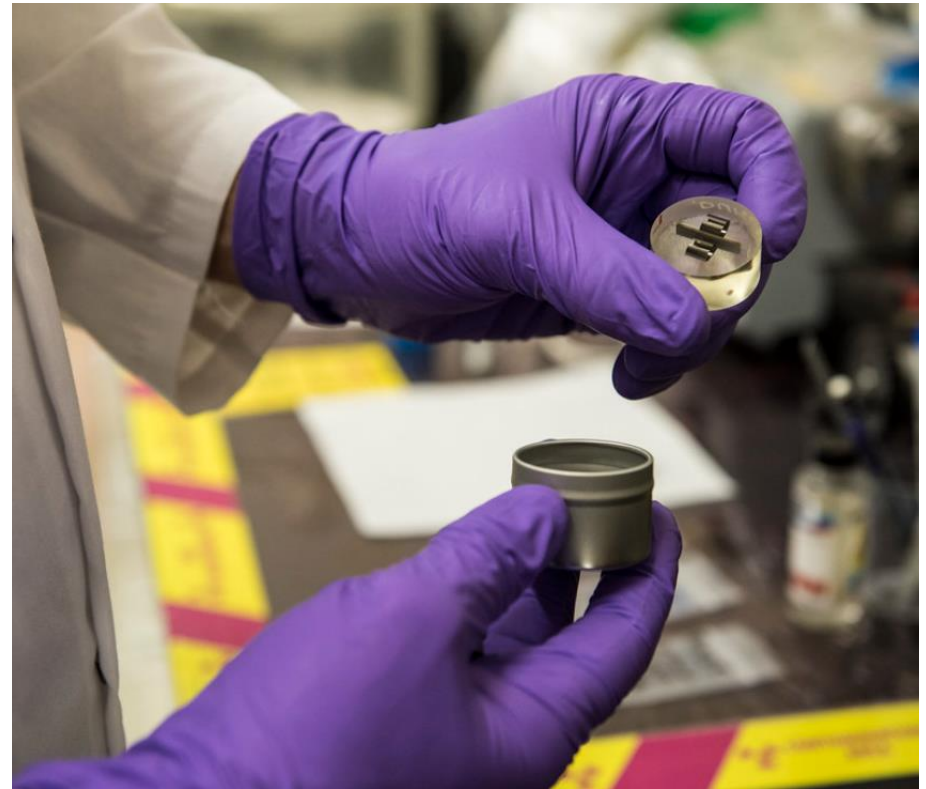
Extracción de cápsula de resina de su molde [2]
