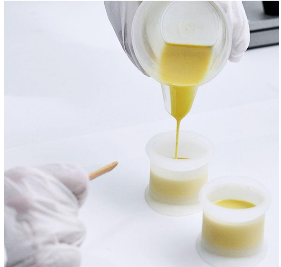
Vaciado de resina para montaje en frío [1]
