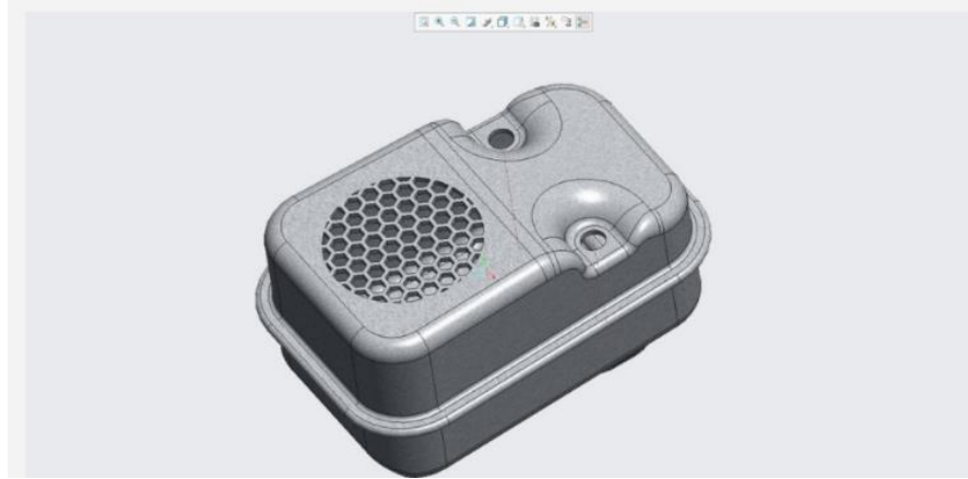
Figura 11. Estructura 2D/3D de honeycomb en una pieza
