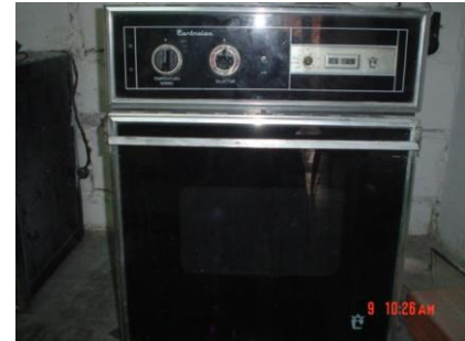
Figura 5. Horno para termoformado
