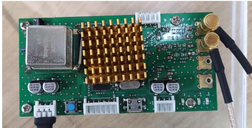
Figura 12: Generador de señales
