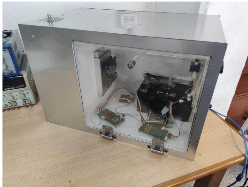
Figura 16: Módulo termoelectrico cerrado con sistema de caracterización dentro
