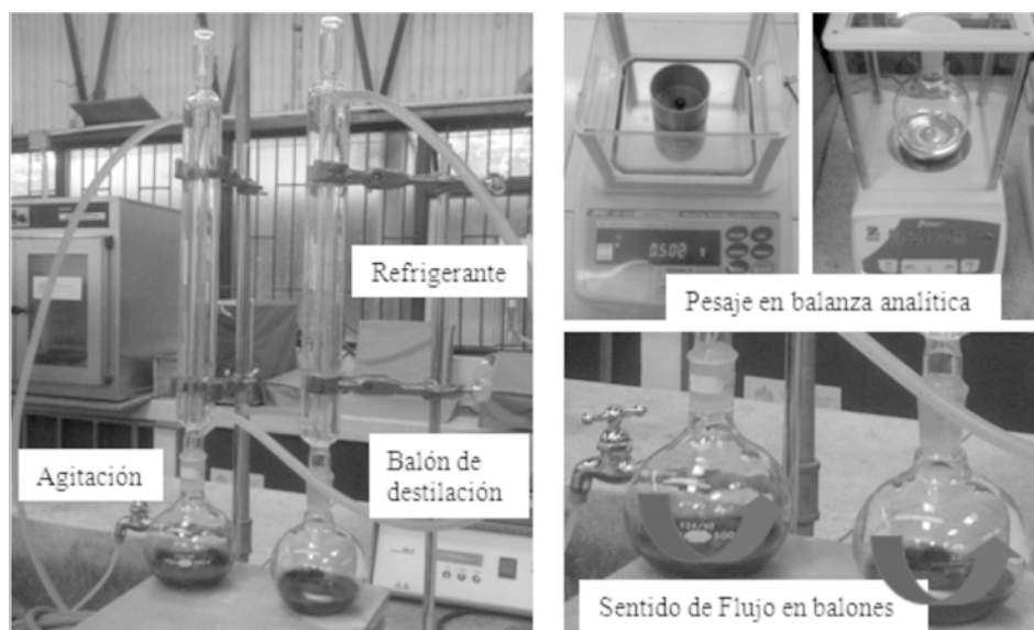
Figura 1. Montaje para ejecutar la separación de los maltenos de los asfaltenos mediante digestión
