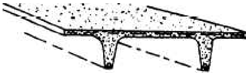
Figura 2-30. Muro en doble T (TPUB, s. f.).
