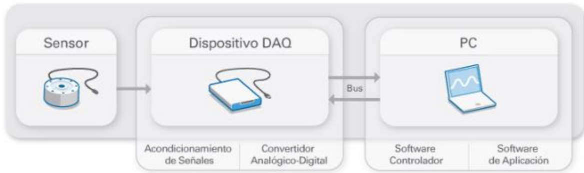
Figura 9. Proceso de adquisición de datos DAQ (NI,sf)
