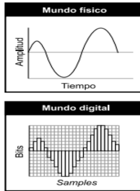
Figura 4. Ejemplo del concepto de frecuencia de muestreo. (Vilanova,sf)
