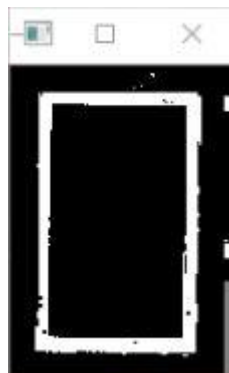
Figura 39 Binarización de imagen aplicada a la figura 38
