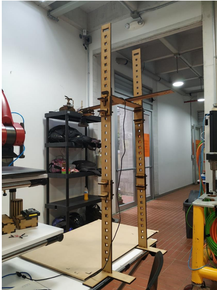
Figura 20 Soporte para cámara web ensamblado
