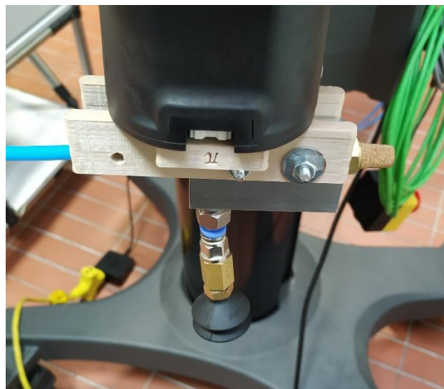
Figura 25 Ventosa y generador de vacío adaptado al manipulador izquierdo del Baxter
