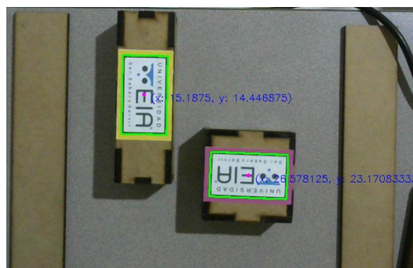
Figura 35 Resultado del cálculo de centroide e identificación de etiquetas en la escena
