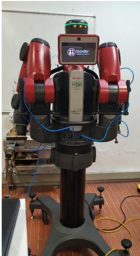
Figura 26 Robot Baxter con las tuberías neumáticas montadas
