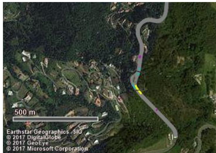
Ilustración 23. Diseño geométrico final del modelo en PTV Vissim con reductores de velocidad en amarillo zona Candelaria. Fuente: Elaboración propia.
