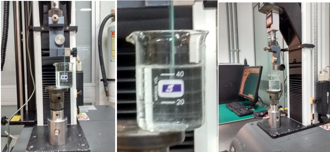
Figura 13. Montaje experimental para hallar la tensión superficial en la INSTRON 3300
