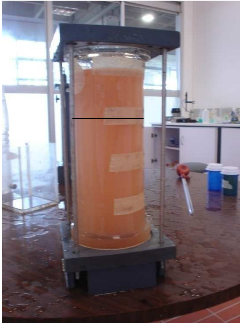
Fotografía 9. Agua residual luego de la flotación por aire disuelto
